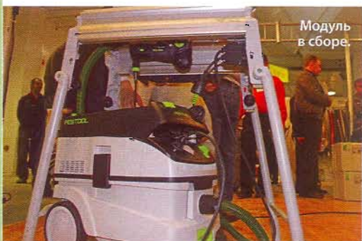
Установка электролобзика в модуль.
