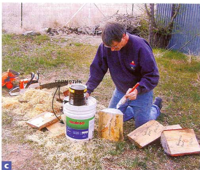
С Нанесите на торцы заготовки герметик, воспользовавшись дешевой кистью шириной 75 мм. Если нужно быстро обработать множество заготовок, делайте это малярным валиком.
