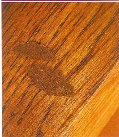
Из-за пористости некоторые шпаклевки для древесины впитывают больше морилки, чем окружающая поверхность.
