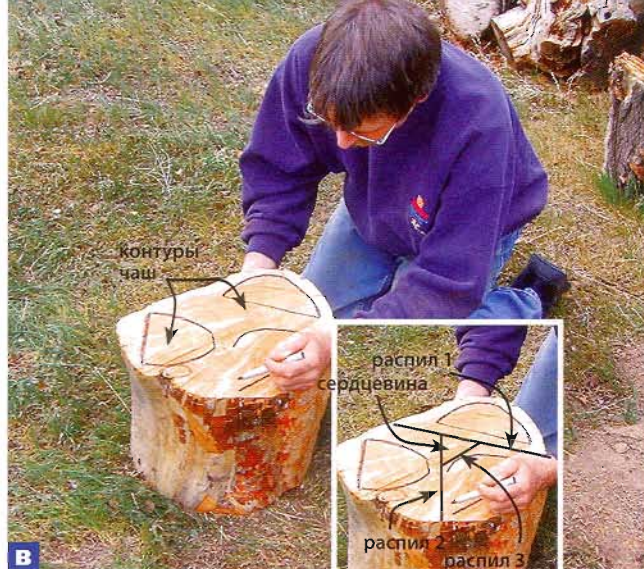
В Из чурбаков неправильной формы часто можно вырезать более двух заготовок. Перед распилом стоит очертить контуры будущих изделий, расположенных вокруг зоны рыхлой древесины.
