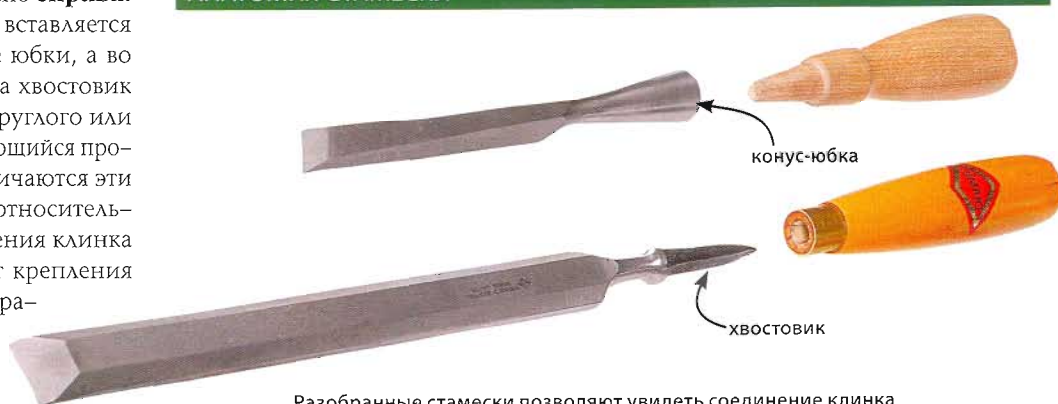
Разобранные стамески позволяют увидеть соединение клинка с ручкой с помощью конуса-юбки и хвостовика.
