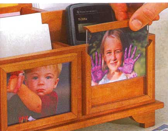
Фотографию можно легко заменить благодаря оргстеклу, вынимающемуся вместе с верхней деталью рамки.
